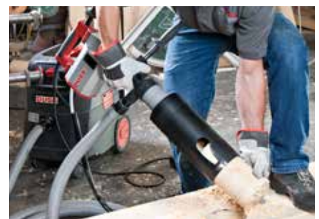
Bohren in Holz mit Staubabsaugung – handgeführt
