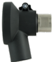
Trockenabsaugung zum Absaugen im Bohrständer bei Trockenbohrungen mit Diamantbohrkronen G 1/2" in Mauerwerk Bestell-Nr. TBS
