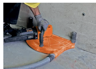
Adapterset für Randnahe-schnitt (Zubehör)
