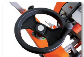
Absenkung über Handrad
