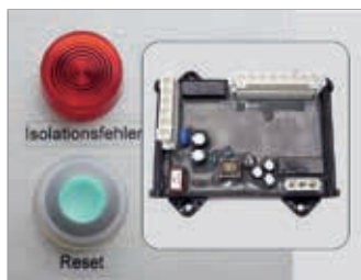
Isolationsüberwachung Der Stromkreis der Verbraucher wird automatisch getrennt, wenn der Isolationswiderstand einen kritischen Wert erreicht hat.
