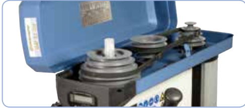
Hochwertige Keilriemen sorgen für eine optimale Kraftübertragung
