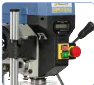
Serienmäßig mit digitaler Drehzahl- und Bohrtiefenanzeige
