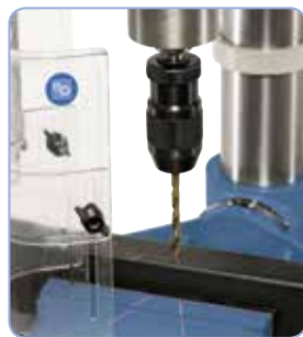
Präzises Arbeiten durch die serienmäßige Kreuzlinien-Lasereinrichtung.
