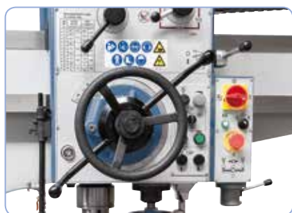
Die Bohrspindel kann auf 3 Arten verfahren werden: Schnellverstellung mittels Handhebel, Feinvorschub mit dem Handrad oder dem automatischen Vorschub
