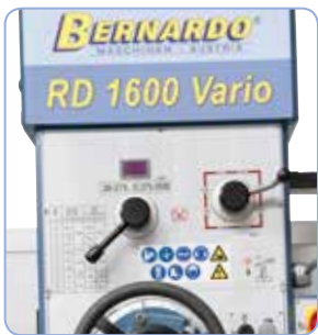
Die Einstellung der gewünschten Drehzahl bzw. des Vorschubs erfolgt an der Vorderseite des Bohrkopfes.
