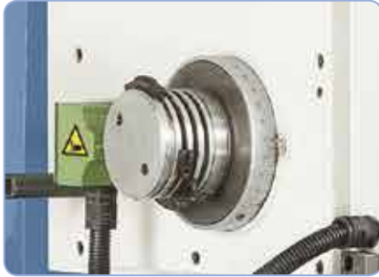
Gewindeschneideinrichtung mit Schnell- bzw. Arbeitsvorschub und Schnellrückhub (ab KBM 63).
