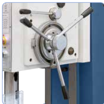
Sterngriff für manuelle Pinolenzuzstellung, Kupplungshebel für automatischen Vorschub.
