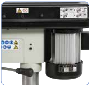
Leistungstarker Aluminium-motor nach IP 54.
