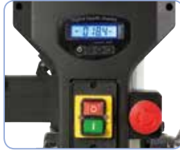
Digitale Bohrtiefenanzeige für komfortables Arbeiten.
