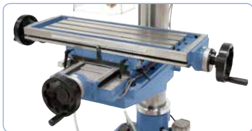
Größdimensionierter Kreuztisch mit T-Nuten, präzise oberflächenbearbeitet
