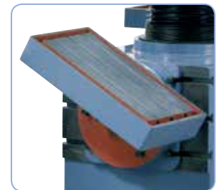
Erweiterter Einsatzbereich durch den von -50° bis +50° schwenkbaren Horizontaltisch (Optional).
