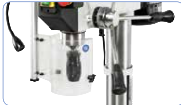
Serienmäßig: Schnellspannbohrfutter 1 - 16 mm
