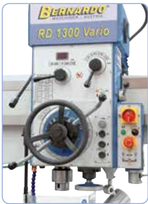
Einfaches Einstellen des Vorschubbereiches und der Drehzahl am Bohrkopf.
