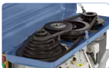
Hohe Laufruhe durch gewuchtete Antriebsscheiben.
