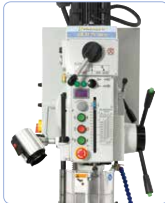
Einfache Vorwahl der Getriebestufe mittels Vorgelege, Einstellen der gewünschten Drehzahl mittels Potentiometer
