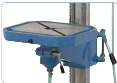
Massiver, handgeschabter Arbeitstisch mit T-Nuten.
