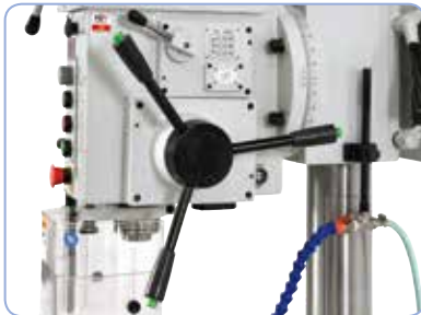
Serienmäßig mit automatischem 3-fach Bohrvorschub ausgestattet
