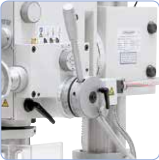
Der Pinolenvorschub kann wahlweise auf 0,10 / 0,18 / oder 0,26 mm/U eingestellt werden.
