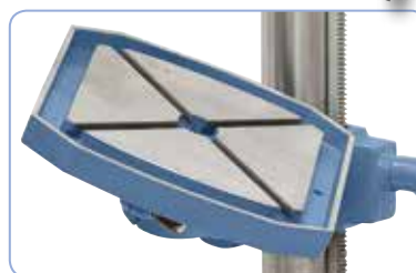
Der Arbeitstisch ist um 360° drehbar, ideal zum Koordinatenbohren.
