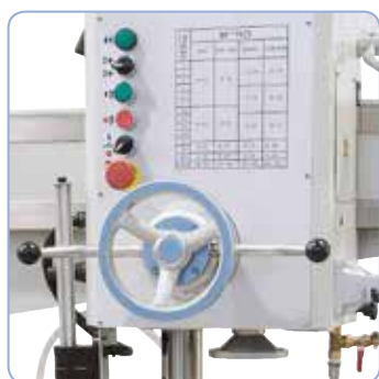
Alle Schalt- und Kontrollelemente sind übersichtlich am Spindelstock angebracht
