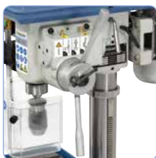
Serienmäßig mit automatischem Pinolenvorschub (V-Modelle).
