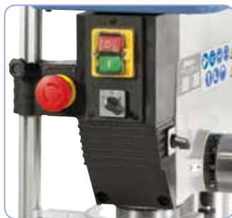
Not-Halt-Taster, Drehrichtungsschalter und 2-Stufenschalter an der Vorderseite der Maschine.
