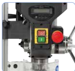
EIN-AUS Schalter nach IP 54 und separater Not-Halt-Taster nach CE-Norm
