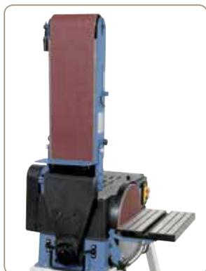
Der Planschleiftisch ist sowohl horizontal als auch vertikal verwendbar
