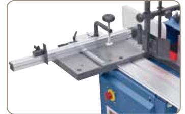
Der serienmäßige Rolltisch aus Grauguss ist plangenau bearbeitet und geschliffen.
