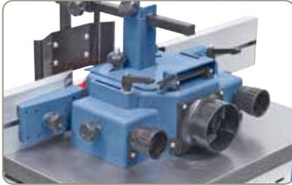
Die Fräferschutzhaube ist mit einer Feineinstellung ausgestattet. Die Späneabfuhr erfolgt durch den integrierten Absauganschluss.
