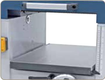
Geschliffener Dickentisch für Werkstücke bis 225 mm Höhe. Die eingestellte Höhe wird mittels Digitalanzeige abgelesen.
