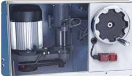
Durch die große Öffnung an der Vorderseite der Maschine kann die Drehzahl schnell und einfach gewechselt werden.
