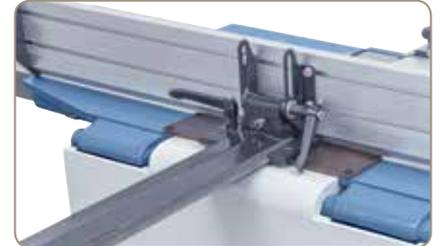
Der Abrichtanschlag wird über eine präzise Prismenführung auf die gewünschte Position eingestellt.
