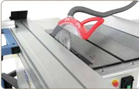
Das Sägeblatt kann für präzise Winkelschnitte von 90° bis 45° geschwenkt werden.
