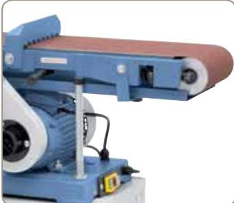
Große Planschleiffläche mit Werkstückanschlag
