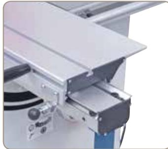
Der verwindungsfreie Formatschiebeschlitten gewährleistet durch die leichtgängige Führung ein präzises Arbeiten.
