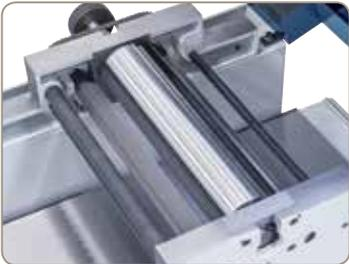
Durch die präzisionsgelagerte 4-Messerwelle und der gerade verzahnten Einzugswalze werden beste Hobelergebnisse erzielt.
