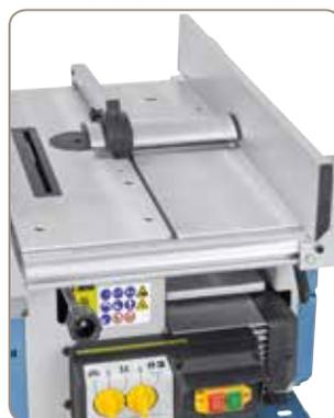
Seitlich geführter Abrichtanschlag, schwenkbar von 90° bis 45°.
