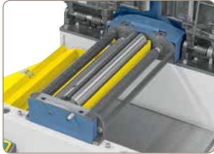
Optimaler Werkstückvorschub durch geriffelte Einzugswalze und gummierter Auszugswalze.
