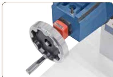
Die Höhenverstellung des Arbeitstisches erfolgt leichtgängig und präzise mittels Handrad.
