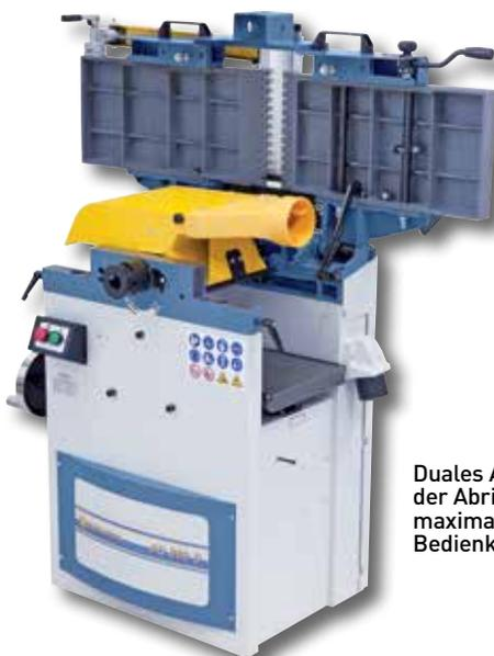
Duales Aufklappen der Abrichttische für maximalen Bedienkomfort.
