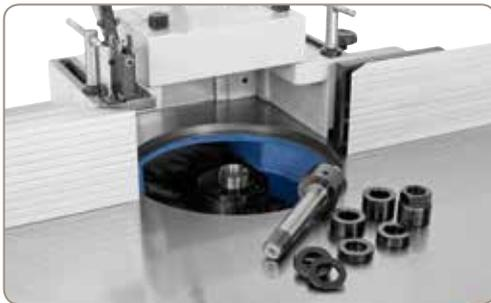
Durch die Wechselspindel wird die Einstellung der Werkzeuge nicht verändert wodurch eine hohe Zeitersparnis bei Serienarbeiten erzielt wird.
