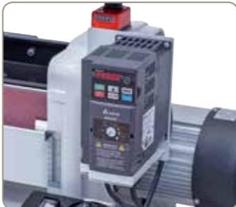
Der hochwertige Frequenzumrichter ermöglicht eine stufenlose Einstellung der Spindeldrehzahl.
