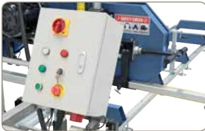
Abbildung mit Elektro-Paneel und Schiebestange für manuellen Vorschub (höhenverstellbar)
