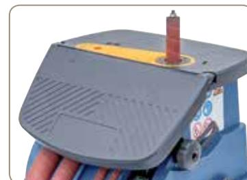
Stufenlos schwenkbarer Arbeitstisch von 0° bis 45°
