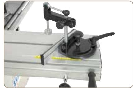
Eine in den Tisch eingearbeitete Skala ermöglicht ein exaktes Einstellen des Gehrungsanschlages.
