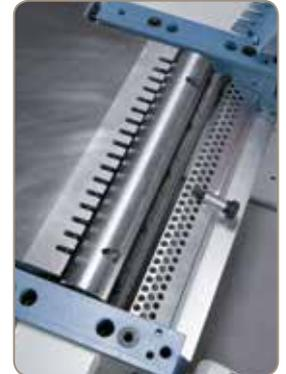
Die Tischlippen in Kombination mit dem gelochten Späneleitblech ergeben eine geringe Lärmbelastung.
