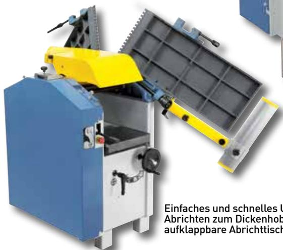
Einfaches und schnelles Umrüsten vom Abrichten zum Dickenhobeln durch aufklappbare Abrichttische.
