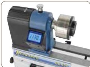
Einfaches Ablesen der Drehzahl mittels LED-Anzeige
