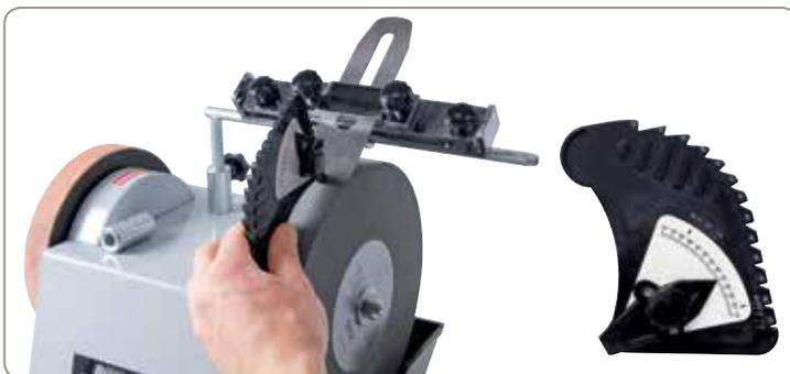
05-2051 Universal-Winkellehre: Zum Messen eines vorhandenen Winkels bzw. zum Einstellen eines Schneidwinkels von 15° bis 75°, geeignet für Schleifscheiben von 150 bis 250 mm Durchmesser
