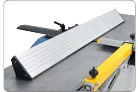
Die Abrichttische aus Grauguss mit geschliffener Oberfläche gewährleisten eine optimale Gleitfähigkeit des Werkstückes.
