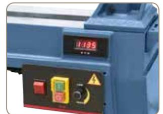
Für ein optimales Einstellen der gewünschten Drehzahl ist die Maschine mit einer digitalen Drehzahlanzeige ausgestattet.
