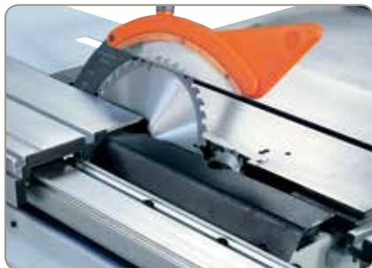
Das bis 45° schwenkbare Sägeaggregat kann mittels Handrad für Schnitthöhen bis 100 mm eingestellt werden.
