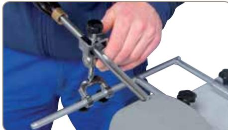
05-2052 Vorrichtung für Drehröhren: Werkzeugdurchmesser max. 20 mm
