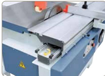
Der großzügig dimensionierte Formattisch läuft leichtgängig und absolut verschleißfrei auf einer gehärteten Prismenführung.
