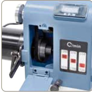
Die Kraftuebertragung auf die Spindel erfolgt ueber einen robusten Riemenantrieb.
