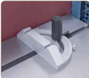
Serienmäßig mit Gehrungsanschlag und Gradskala für genauen Winkelschliff.
