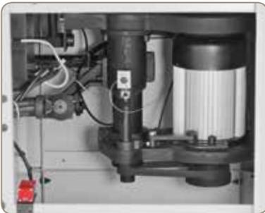
Das Fräsaggregat aus Grauguss ist leicht zugänglich, wodurch ein problemloser Drehzahlwechsel möglich ist.
