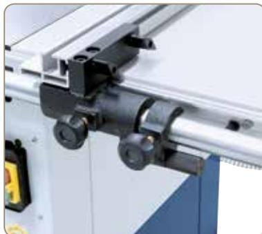
Der mit einer mikrometrischen Feineinstellung ausgerüstete Parallelanschlag kann für Schnittbreiten bis 670 mm verwendet werden.
