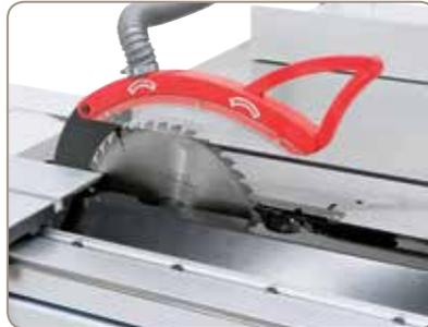
Serienmäßig mit Vorritzaggregat für ein ausreißfreies Bearbeiten von Plattenwerkstoffen.
