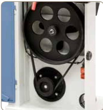
Die robuste Keilriemenscheibe und der hochwertige Keilriemen sorgen für eine optimale Kraftübertragung vom Motor.
