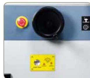
Schnelle und einfache Höhenverstellung der Frässpindel mittels Handrad, ablesbar über Lupe.
