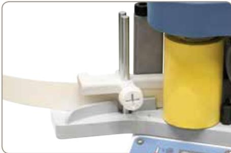
Das einstellbare Führungssystem erlaubt die Verwendung von Kantenstärken von 0,3 – 3,0 mm und Kantenhöhen von 10 – 65 mm
