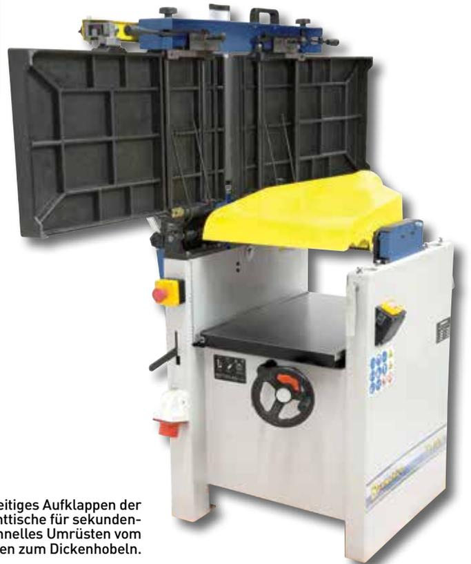
Gleichzeitiges Aufklappen der Abrichttische für sekundenschnelles Umrüsten vom Abrichten zum Dickenhobeln.
