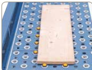
Serienmäßig mit Anschlägen zum Positionieren des Werkstückes.
