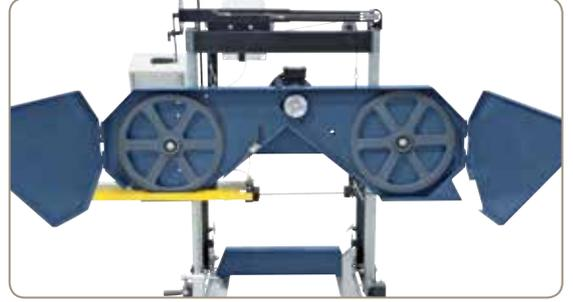
Einfacher Sägebandwechsel durch aufklappbare Abdeckungen
