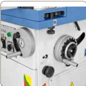
Die Schwenkung des Fräsaggregates erfolgt mittels ergonomisch angebrachtem Handrad, die Grad-einstellung ist analog ablesbar.
