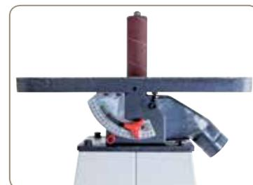
Serienmäßig mit Absaugstutzen zum Anschließen einer Absauganlage
