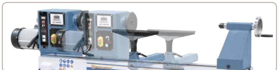
Der Spindelkasten kann in Langsrichtung beliebig verschoben und arretiert werden.
