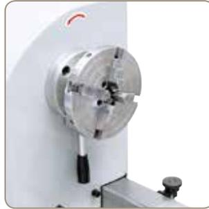
Stabiler Spindelstock für vibrationsfreies und sauberes Arbeiten. Abbildung mit 4-Backen-Spannfutter 150 mm / M 33 (Option)
