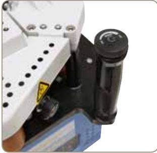
Komfortable Vorschubregelung von 2 - 6 m/min am Handgriff, ideal zum Bearbeiten unterschiedlichster Werkstücke
