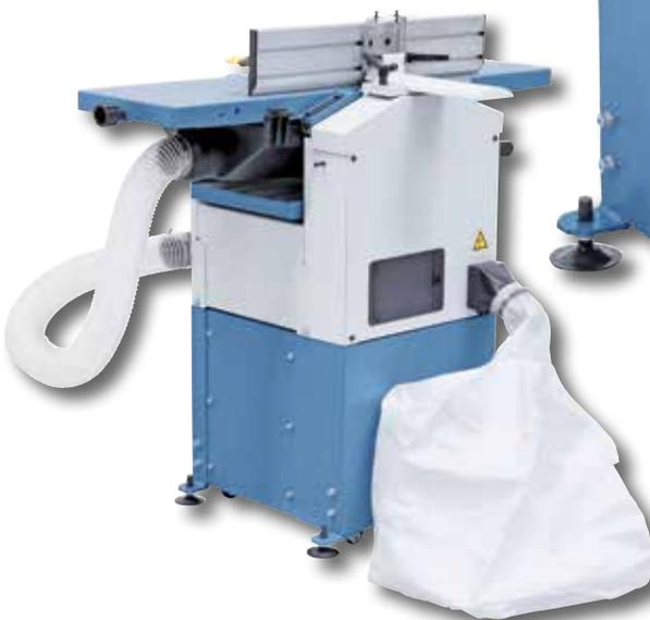
Serienmäßig mit integrierter Späneabsaugung und Filtersack ausgestattet.
