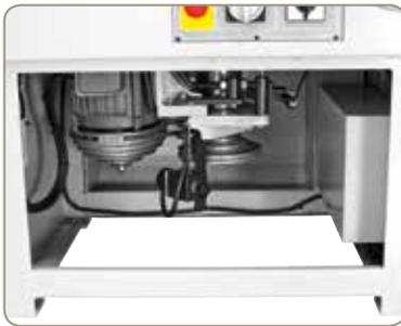
Einfacher Riemenwechsel zur Geschwindigkeitswahl über großzügige Öffnung an der Maschinenfront.
