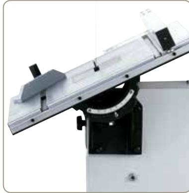
Der Arbeitstisch ist von 0° auf 45° schwenkbar, gewünschte Einstellung mittels Skala ablesbar.
