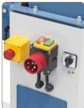
Not-Aus- und Drehrichtungsschalter seitlich am Maschinenkörper
