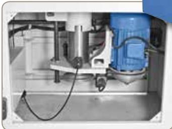
Das großdimensionierte Fräsaggregat aus Grauguss mit der dynamisch ausgewuchteten Frässpindel gewährleistet ein vibrationsfreies Arbeiten und dadurch optimale Arbeitsergebnisse.
