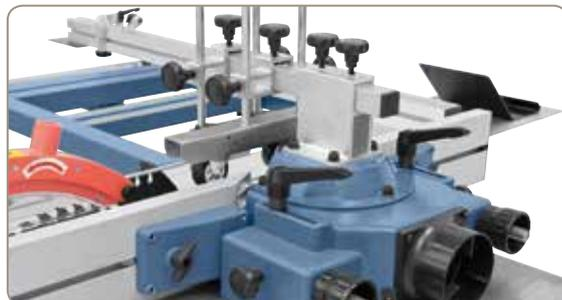
Die Aluminium-Anschlagsschienen können schnell und einfach auf das jeweilige Fräs Werkzeug eingestellt werden und sind zusätzlich mit einer Feineinstellung ausgestattet.
