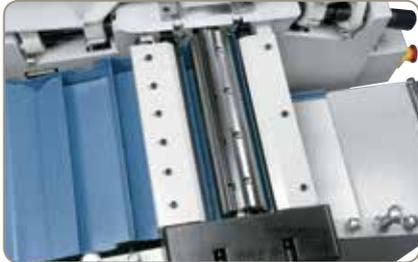
Die dynamisch ausgewuchtete 3-Messerielle garantiert durch den vibrationsfreien Lauf beste Hobelergebnisse.
