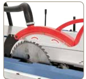
Serienmäßig mit Vorritzaggregat für ein ausreißfreies Bearbeiten von Plattenwerkstoffen.
