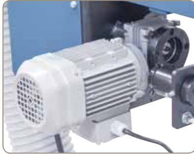
Wartungsfreier Getriebemotor für die Schleifbandoszillation.
