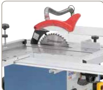
Der Sägeblattschutz mit integriertem Absaugen ist am Spaltkeil befestigt.
