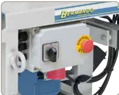
Elektrobox mit Steckeranschluss.
