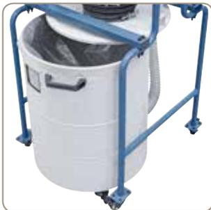
Durch den ausfahrbaren Abfüllbehälter wird ein schnelles und einfaches Entleeren des Spänesackes gewährleistet.
