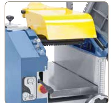
Stabiler Dickentisch aus Grauguss mit mittiger Zentralführung und Klemmung, zum Hobeln von Werkstücken bis 190 mm Höhe.
