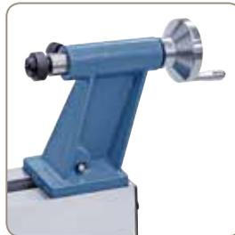
Pinole mit Durchgangsbohrung, ideal zum Herstellen z.B. von Kabelkanälen in Lampensockeln.
