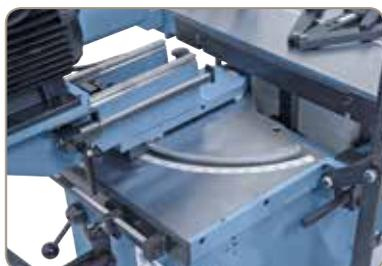
Bohraggregat rechts und links 60° schwenkbar
