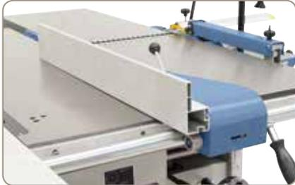
Abklappbarer Parallelanschlag mit mikro-metrischer Feineinstellung.
