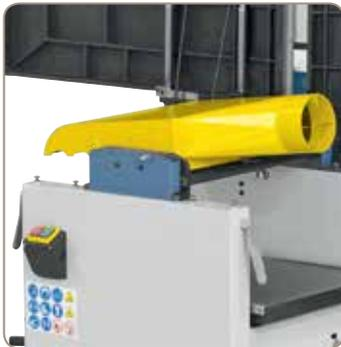
Integrierte umklappbare Spanauswurfhaube – Anschlussdurchmesser 120 mm.
