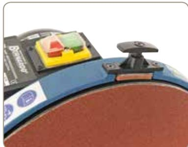
Manuelle Bremse stoppt das Schleifteller innerhalb von Sekunden
