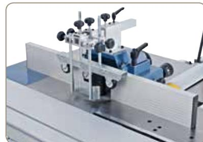
Die Fräseschutzhaube ist mit eloxierten Aluminium-Anschlagschienen ausgestattet.
