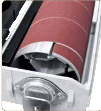
Schnellspannsystem zum Befestigen des Schleifbandes.
