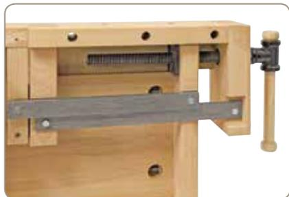
Zinkenverleimte Hinterzange mit stabiler Führung
