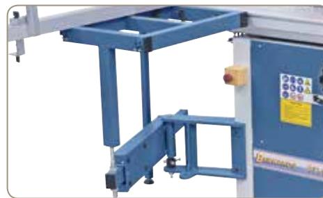
Der leichtgängige Auslegertisch ist zusätzlich mit einem Schwenkarm ausgestattet, wodurch das Bearbeiten von großen Platten ermöglicht wird.
