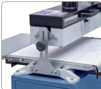
Klemmsystem zum Fixieren der Schleifeinheit.
