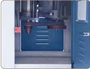
Schneller und einfacher Drehzahlwechsel mittels Keilriemen.
