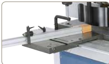
Der Rolltisch aus Grauguss ist plangenau bearbeitet und geschliffen.
