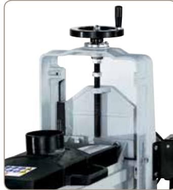
Stabiles Führungssystem, Höhenverstellung mittels Handrad.
