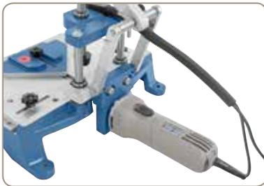
Der 850 W Motor ist geeignet zur Herstellung der Schwalbengrößen W-1, W-2 und W-3
