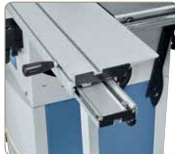
Gehärtete Prismenführung für einen leichtgängigen Lauf des Formattisches.
