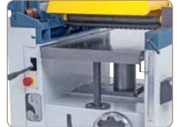
Stabiler Dickenanschub mit Pinolenführung und Abstützung für exaktes Hobeln von Bretter, Leisten, Bohlen, ...
