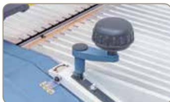
Schnelle und einfache Einstellung der Spanabnahme bis max. 2 mm.
