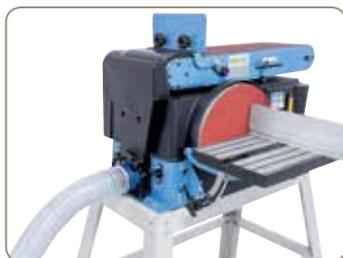
Serienmäßig mit integriertem Absaugstutzen für den Anschluss einer Absauganlage
