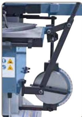
Serienmäßig mit Schablonenvorrichtung zum Bohren von schrägen Schlitzen
