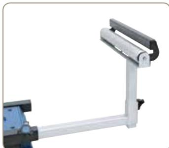
Rollenauflage beidseitig stufenlos auszieh- und höhenverstellbar
