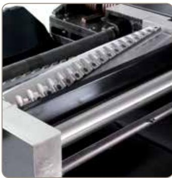
Das Hobelwerk besteht aus einer dynamisch ausgewuchteten Spiralhobel-Messerwelle, einer Ein- und Auszugswalze, sowie massiven Rückschlag-sicherungen.
