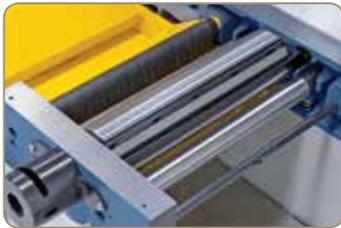
Die stabile Hobeinheit mit der präzisionsgelagerten 3-Messerwelle gewährleistet beste Hobelergebnisse.
