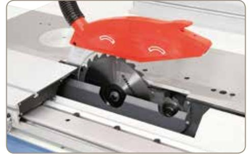
Der Sägeblattschutz mit integriertem Absaugstutzen ist am Spaltkeil befestigt. Serienmäßig mit Vorritzaggregat ausgestattet.
