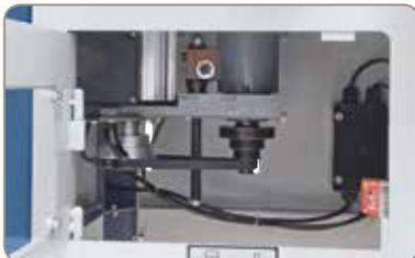
Schnelles und einfaches Wechseln der Drehzahl mittels Keilriemen.
