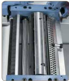
Durch die präzisionsgelagerte 4-Messerwelle und der spiralverzahnten Einzugswalze werden beste Hobelerggebnisse erzielt.
