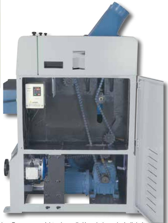
Mit dem Frequenzumrichter kann die Vorschubgeschwindigkeit der Ein- und Auszugswalze für präzise Hobelerggebnisse optimal an das Werkstück angepasst werden
