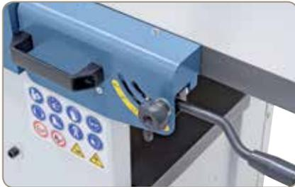
Schnelle und einfache Einstellung der Spanabnahme bis max. 3 mm.
