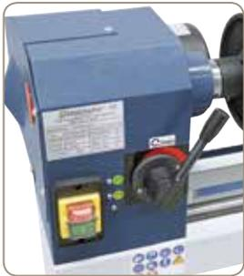
Optimale Anpassung der Drehzahl durch die stufenlose Regelung
