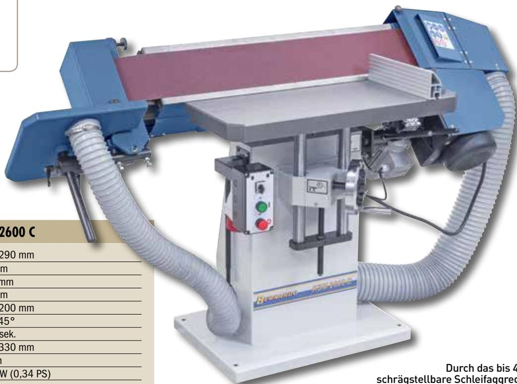
Durch das bis 45° schrägstellbare Schleifaggregat und der starren, waagrechten Position des Arbeitstisches wird das Bearbeiten von schweren Werkstücken wesentlich erleichtert.
