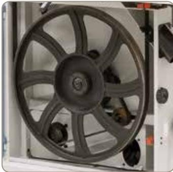
Das Antriebsrad mit Spezialgummi-bandage sorgt für einen ruhigen Lauf und erhöht die Lebensdauer des Sägebandes.
