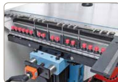
Anschlagfingerleiste mit 3 Aussparungen zur Verwendung von Kombibohrsegmenten für Topfbänder
