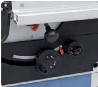
Problemlose und leichtgängige Schwenkung des Sägeblattes mittels Handrad über eine Zahnkranzföhrung.
