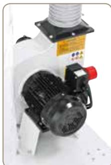
Leistungsstarker Antriebsmotor mit Stahllüfterrad
