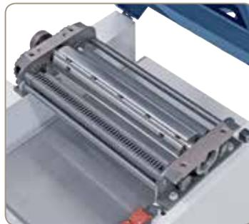
Das robuste Hobelaggregat mit der 70 mm starken Hobelmesserwelle sorgt für ein plangenaues Hobelergebnis.
