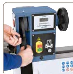
Einfaches Wechseln der Übersetzungsstufe durch Umlegen des Keilriemens.
