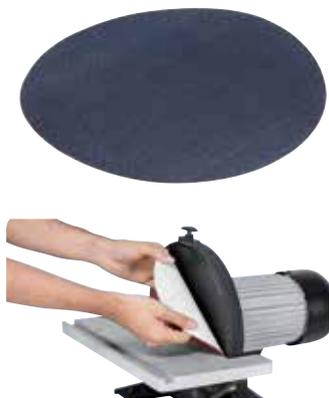
Die Klettauflagen sind auf der Rückseite selbstklebend und werden auf den Teller der Schleifmaschine geklebt. So kann ein schneller Wechsel zwischen unterschiedlichen Körnungen der Schleifmittel erfolgen.
