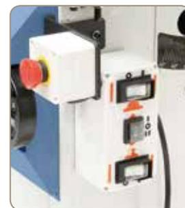
Alle Schaltelemente sind in einem Elektropaneel übersichtlich montiert.
