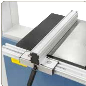
Leicht verstellbarer Aluminium-Anschlag mit Schnellklemmung, Ablesung der mm-Skala über eine Lupe.
