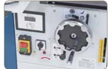
Elektronische Anzeige der eingestellten Spindeldrehzahl.
