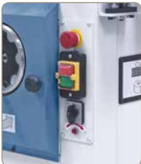
Die elektrischen Schaltelemente sind ergonomisch an der Vorderseite der Maschine angebracht.
