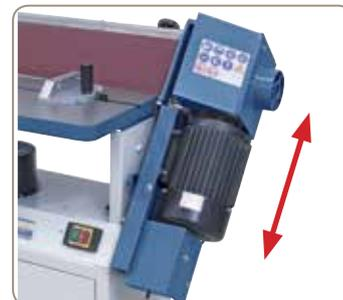
Linearführung des Schleifaggregates in vertikaler Richtung (anstelle Schwenkbewegung) für einwandfreie Schleifergebnisse.
