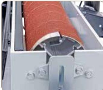
Schnellspannsystem zum Befestigen des Schleifbandes.
