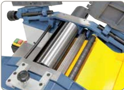
Hobelwerk bestehend aus: 3-Messerwelle, geriffelte Einzugswalze, gummierte Auszugswalze.
