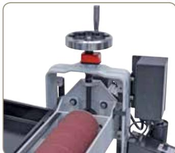
Stabiles Führungssystem, Höhenverstellung mittels Handrad.
