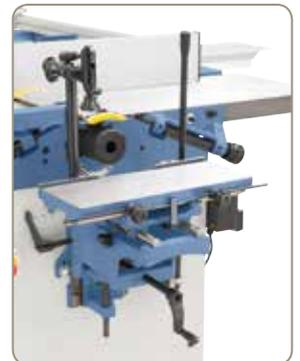
Die serienmäßige Langlochbohrereinrichtung ist ideal für Langlöcher, Dübel- und Schräglöcherbohrungen,....
