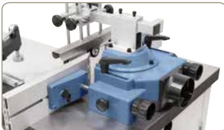
Der massive Fräseranschlag kann für Werkzeuge bis 200 mm verwendet werden. Die beidseitigen Anschlagsschienen sind serienmäßig mit einer Feineinstellung ausgestattet.
