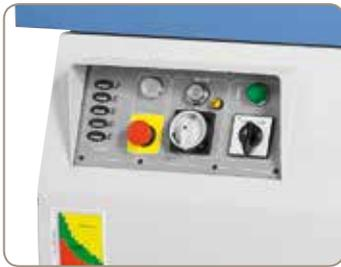
Die Bedienung der Elektrokomponenten erfolgt bequem an der Frontseite der Maschine. LED's zeigen die eingestellte Drehzahl an.
