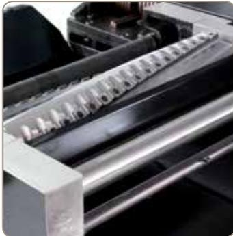
Durch die präzisionsgelagerte Spiralmesser-Hobelwelle und der gerade verzahnten Einzugswalze werden beste Hobelergebnisse erzielt.
