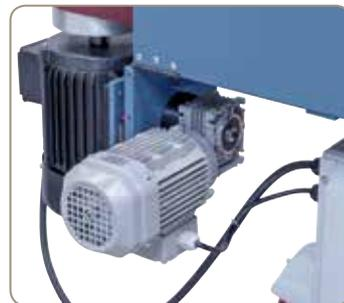
Schleifband-Oszillation mit separatem Getriebemotor.
