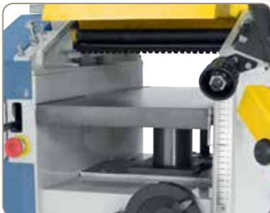
Dicktisch aus Grauguss mit mittiger Zentralsäule und Abstützung, für Werkstücke bis 180 mm Höhe.
