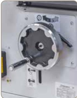
Schnelle und einfache Höhenverstellung der Spindel mittels ergonomisch angebrachtem Handrad.
