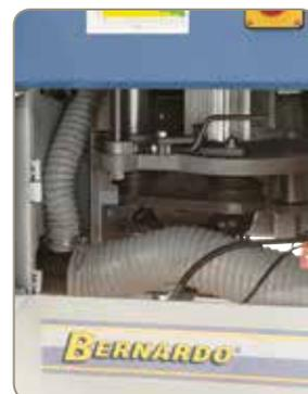
Einfacher Riemenwechsel zur Geschwindigkeitswahl der Frässpindel über großzügige Öffnung an der Maschinenfront.
