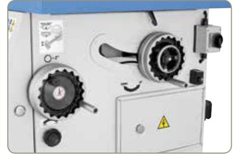
Die Schwenkung des Fräsaggregates erfolgt mittels ergonomisch angebrachtem Handrad, die Gradeinstellung ist auf einer Digitalanzeige ablesbar.
