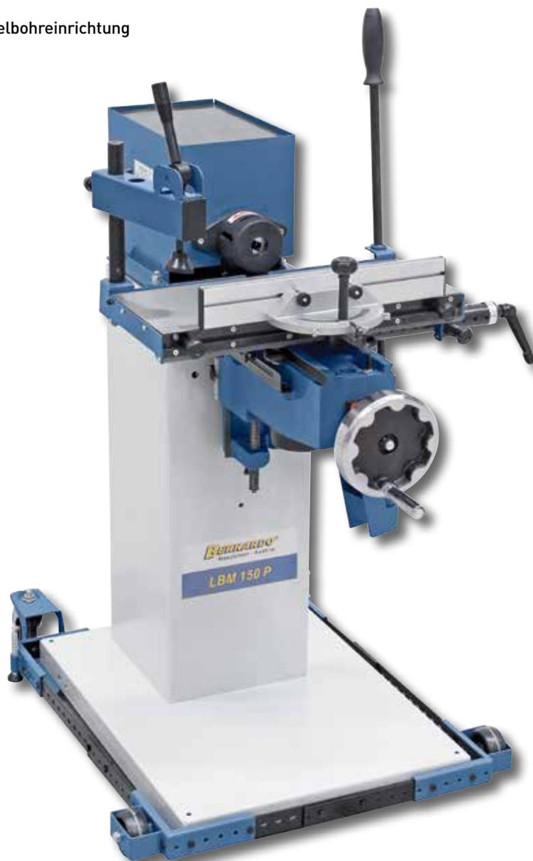
Das optional erhältliche Universalfahrwerk ermöglicht einen leichten Standortwechsel.
