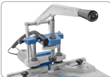
Funktionsweise: Beim Herunterdrücken des Hebels wird das Werkstück geklemmt und dann verfährt der Fräser bis zur voreingestellten Frästiefe. Beim Hochheben des Hebels in die Ausgangsposition wird das gefräste Werkstück freigegeben und der Motor schaltet automatisch ab.
