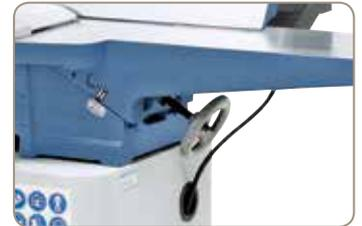
Leichte Einstellung der Spanabnahme mittels Handrad
