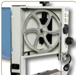
Die präzisionsgelagerten Antriebsräder aus Aluminium mit Gummibandagen sorgen für einen optimalen Lauf des Sägebandes.
