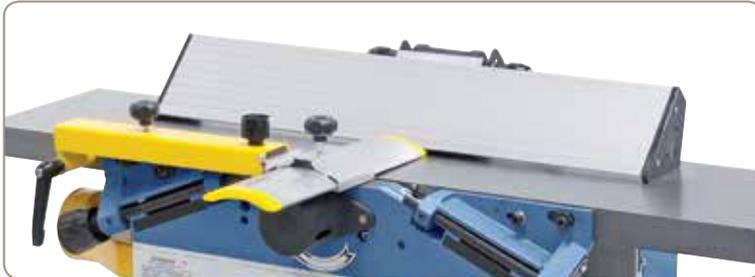
Der massive, bis 45° schrägstellbare Abrichtanschlag mit Prismenführung ist leicht verstellbar.
