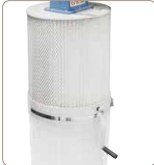
Filterpatrone inklusive Reinigungsbürste zum Entfernen des Feinstaubes.
