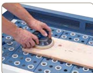
Gummierte Tischauflagen verhindern ein Zerkratzen des Werkstückes.
