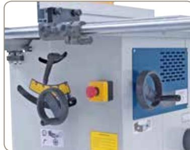
Die Höhenverstellung bzw. Schwenkung des Sägeaggregates erfolgt mittels ergonomisch angebrachten Handrädern.
