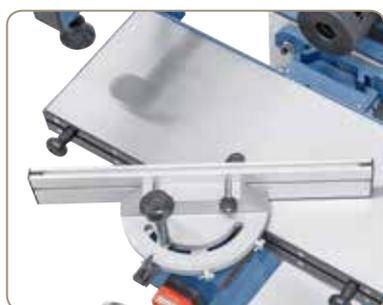
Verstellbarer Gehrungsanschlag, 2 x 60° schwenkbar.
