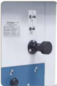
Die Spindelarrretierung ermöglicht ein schnelles und einfaches Wechseln des Fräswerkzeuges.
