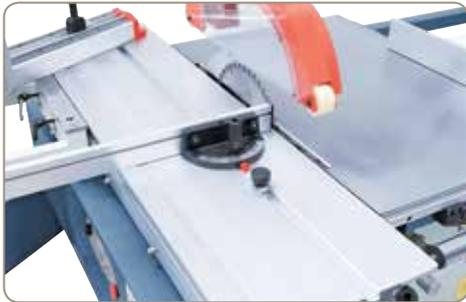
Die T-Nut im Formattisch ermöglicht das Montieren von diverserem Zubehör, z.B. Besäumschuh, Exzenter-Niederhalter, Teleskopanschlag, usw.
