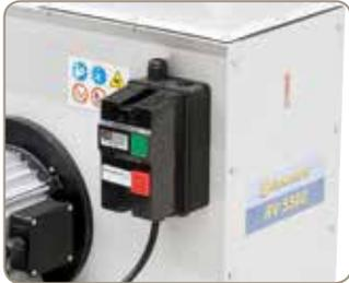
Ein-Ausschalter nach IP 54 mit Unterspannungsauslöser.
