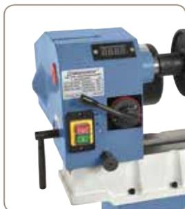
Für ein optimales Einstellen der gewünschten Drehzahl ist die Maschine mit einer digitalen Drehzahlanzeige ausgestattet.
