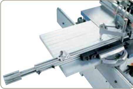
Durch den optionalen Rolltisch mit ausziehbarem Teleskopanschlag und Exzenterspanner wird der Einsatzbereich zusätzlich erhöht.
