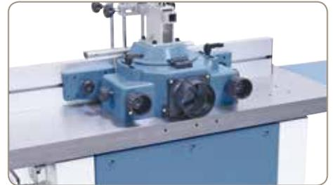
Die Aluminium-Anschlagschienen können schnell und einfach auf das jeweilige Fräswerkzeug eingestellt werden und sind zusätzlich mit einer Feineinstellung ausgestattet.
