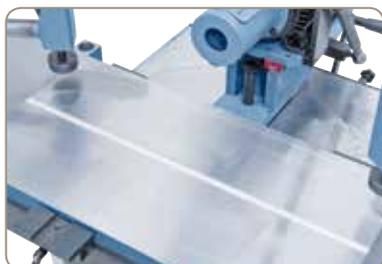
Eingelassene Skala im Bohrtisch mit mittigem Nullpunkt
