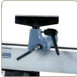
Einfache Fixierung der Handauflage mittels Schnellspannhebel.
