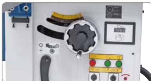
Elektronische Anzeige der eingestellten Spindel-drehzahl.
