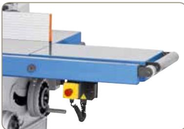
Die Einlaufrolle und die ausziehbare Tischverbreiterung erleichtern das Handling bei längeren Werkstücken.
