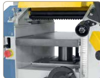
Dickentisch aus Grauguss mit mittlerer Zentralsäule und Abstützung, für Werkstücke bis 180 mm Höhe.
