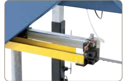
Präzise geführtes Sägeband und Kühlmittelzufuhr sorgen für optimale Schnittergebnisse
