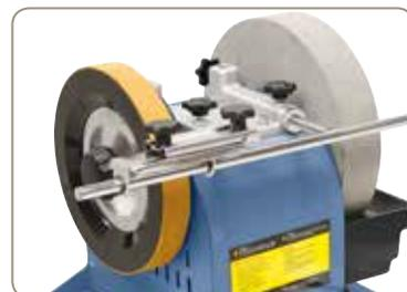
Inklusive Lederabziehscheibe zum Entfernen des Grates nach dem Schleifvorgang.
