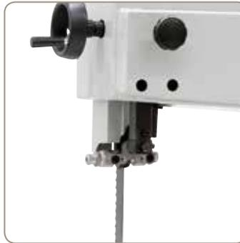
Inklusive Präzisions-3-Rollen-Sägebandführung über und unter dem Säge Tisch
