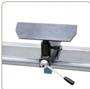
Einfache Fixierung der Handauflage mittels Schnellspannhebel.
