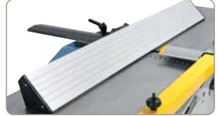
Der Abrichtanschlag wird über eine präzise Prismenführung auf die gewünschte Position eingestellt.
