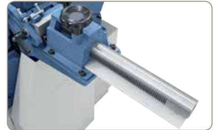
Der Abrichtanschlag wird über eine präzise Führungsstange auf die gewünschte Position eingestellt.
