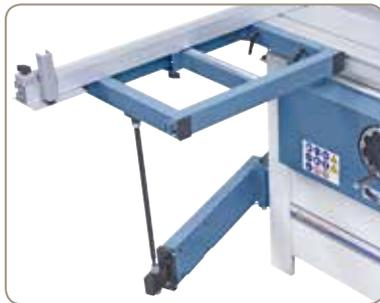
Das Aluminium-Anschlaglineal kann am Auslegertisch sowohl vorne als auch hinten montiert werden.
