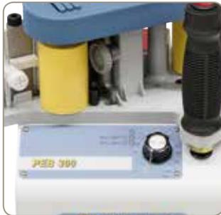
Die gewünschte Arbeitstemperatur wird mittels Potentiometer eingestellt.
