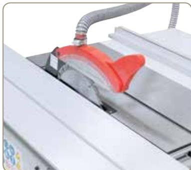
Der Sägeblattschutz mit integriertem Absaugstutzen ist am Spaltkeil befestigt.
