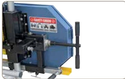
Bedienerfreundliche Sägebandspannung, leicht zugänglich
