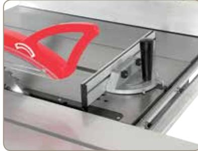
Gehrungsanschlag für kleine Werkstücke, über die ganze Tischlänge verschiebbar
