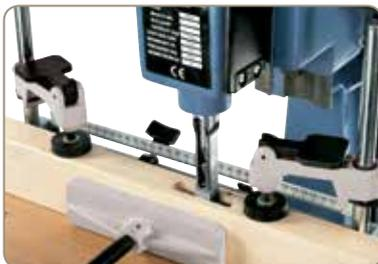
Exzentranspanner und Schnellspann-Schraubstock zur sicheren Fixierung des Werkstückes
