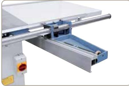
Abklappbarer Parallelanschlag mit mikrometrischer Feineinstellung (Vorteil bei großen Platten)
