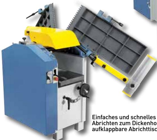
Einfaches und schnelles Umrüsten vom Abrichten zum Dickenhobeln durch aufklappbare Abrichttische.
