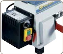
Durch die stufenlose Drehzahlregelung kann die Geschwindigkeit optimal an das Werkstück angepasst werden.
