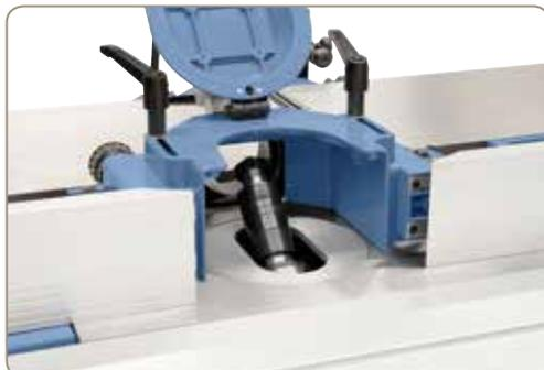
Die nach hinten schwenkbare Frässpindel hat folgende Vorteile: Optimaler Einsatz eines Vorschubapparates, ein Maximum an Sicherheit und ein sauberes Fräsbild.
