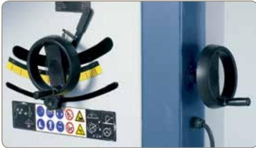
Die Verstellung des Sägeaggregates erfolgt durch ergonomisch angebrachte Handräder am Maschinenkörper.
