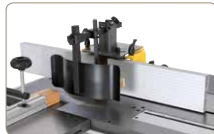
Die Anschläge der Fräferschutzhaube können schnell und einfach auf das jeweilige Fräswerkzeug eingestellt werden. Die serienmäßige Schutzvorrichtung verhindert ein Rückschlagen des Werkstückes.
