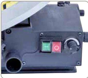
Die Hubzahl wird mittels Potentiometer stufenlos eingestellt.
