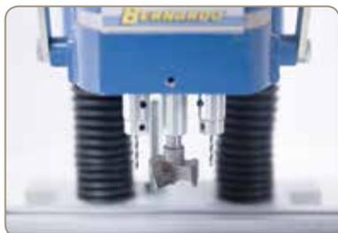
3-Spindelbohrkopf mit Beschlagbohrer diam. 35 mm links und 2 Stk. Bohrer diam. 2 mm rechts
