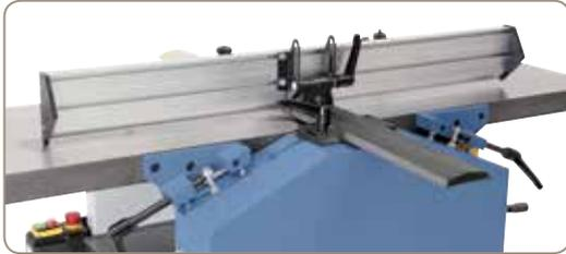
Die Abrichttische aus Grauguss mit geschliffener Oberfläche gewährleisten eine optimale Gleitfähigkeit des Werkstückes.
