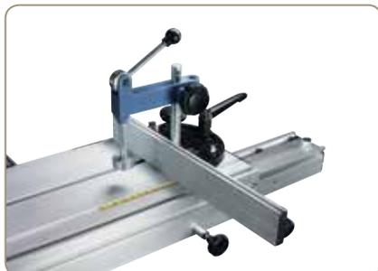
Die T-Nut im Formattisch ermöglicht das Montieren des Gehrungsanschlages und des Besäumschuhs.
