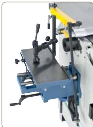
Die optional erhältliche Langlochbohrereinrichtung ist ideal für Langlöcher, Dübel- und Schräglochbohrungen.
