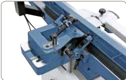
Robuste Schwenkeinrichtung des Abrichtanschlages mit justierbaren Endanschlägen
