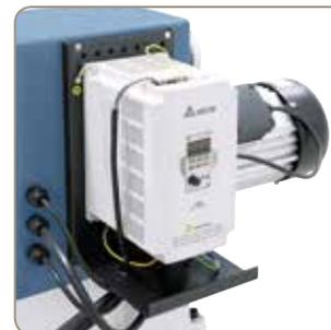
Der hochwertige Frequenzumrichter ermoglicht eine stufenlose Einstellung der Spindeldrehzahl.
