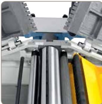
Durch die präzisionsgelagerte 4-Messerwelle und der gerade verzahnten Einzugschwelle werden beste Hobelergebnisse erzielt.
