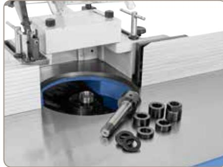
Durch die Wechselfspindel wird die Einstellung der Werkzeuge nicht verändert, wodurch eine hohe Zeitersparnis bei Serienarbeiten erzielt wird.
