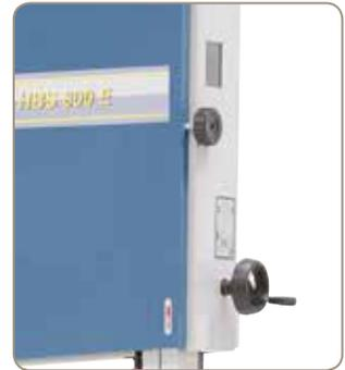
Sichtfenster für Bandlauf und Schnitthöhenverstellung an der Stirnseite
