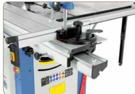
Der großzügig dimensionierte Formattisch läuft leichtgängig auf einer gehärteten Prismenführung.
