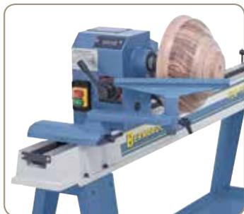
Zum Bearbeiten größerer Werkstücke kann der Spindelkopf um 90° geschwenkt werden.
