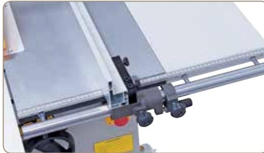
Präzise Führung des Aluminium-Parallelanschlages mittels 30 mm Rundstange.
