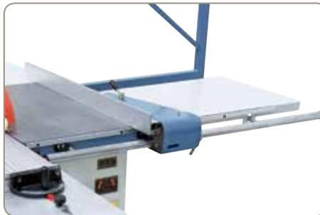
Parallelanschlag mit Schnell- und Feineinstellung für Schnittbreiten bis 1295 mm.
