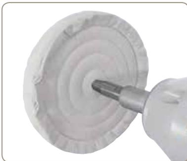
Mit spitzen Wellenenden zur Aufnahme von Polierscheiben mit einer Bohrung von 16 bis 30 mm
