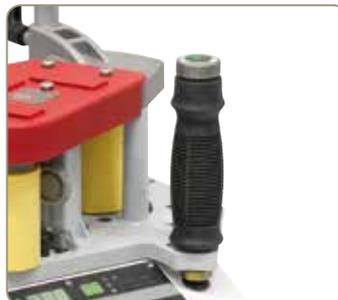
Komfortable Vorschubregelung von 2 – 6 m/min am Handgriff, ideal zum Bearbeiten unterschiedlichster Werkstücke
