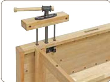
Französische Vorderzange mit Trapezgewindespindel und Parallelstabführung
