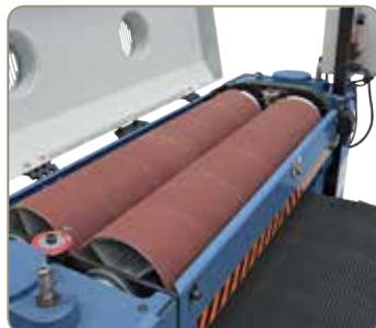
2 Schleifbandwalzen für Grob- und Feinschliff in einem Schleifvorgang.
