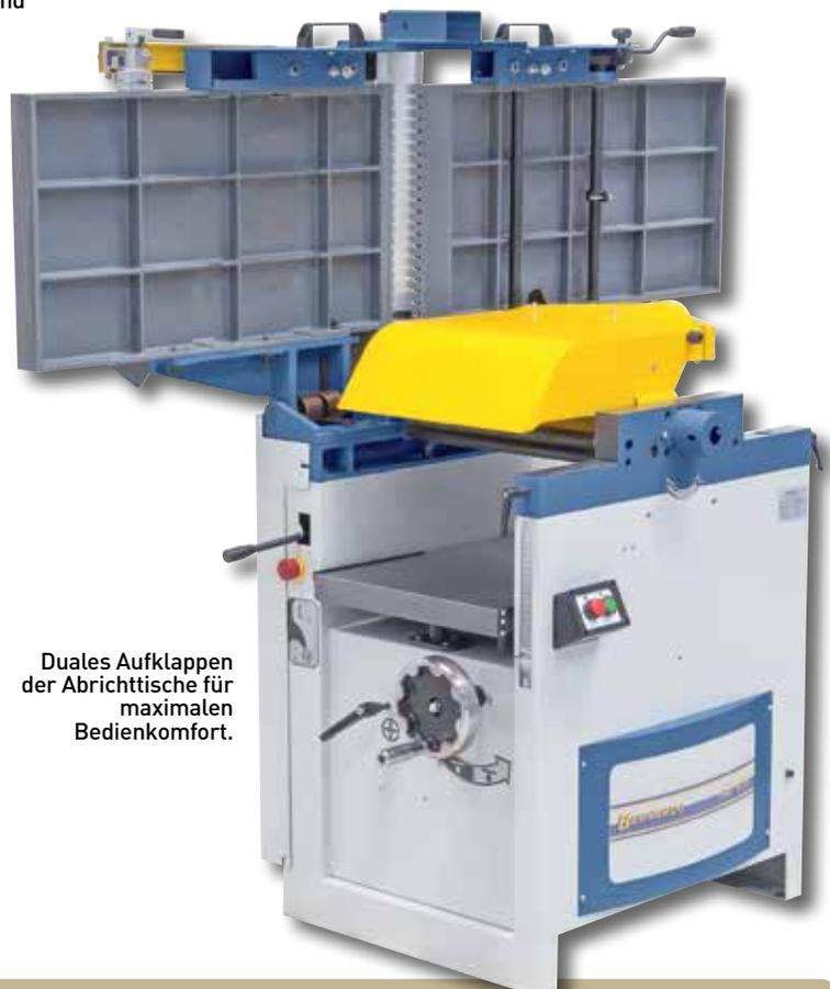
Duales Aufklappen der Abrichttische für maximalen Bedienkomfort.
