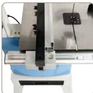
Der Längsanschlag ermöglicht durch die integrierte Lupe ein exaktes Ablesen der eingestellten Schnittbreite
