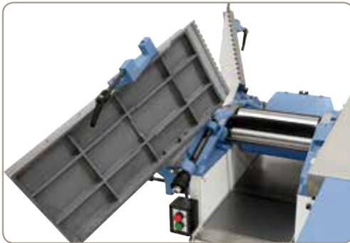
Die hochklappbaren Abrichttische ermöglichen beim Dickenhobeln ein optimales und sicheres Arbeiten, auch bei kurzen Werkstücken.
