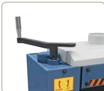
Arbeitstisch wird mittels Handrad und Skala an die Werkstückdicke angepasst.
