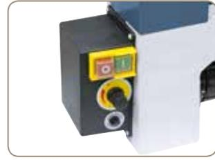
Optimale Anpassung der Drehzahl durch die stufenlose Regelung
