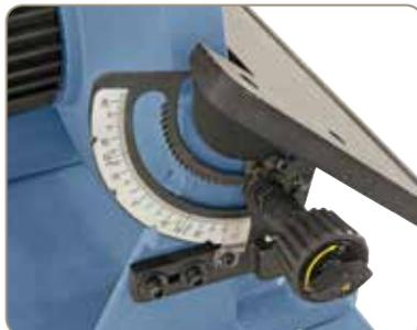
Geschliffener Graugusstisch mit Schwenkbereich -3° bis +45°
