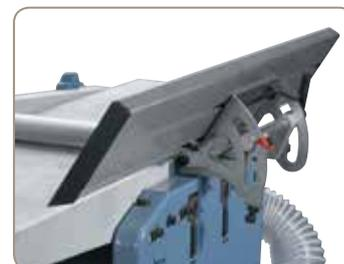
Die Schwenkung des Abrichtanschlages erfolgt schnell und einfach an der Rückseite. Die gewünschte Gradeinstellung kann an der Skala abgelesen werden.
