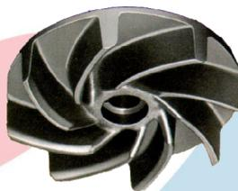
Das Freistromrad wird eingesetzt, um einen verstopfungsfreien Betrieb zu gewährleisten und um Abnutzung durch grobe oder faserige Feststoffe zu vermeiden. Das Laufrad erzeugt einen Wirbel von hoher Geschwindigkeit, der das Wasser vom Einlaß zum Auslaß befördert.
