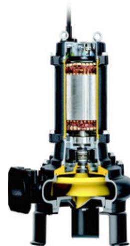
Die Saugplatte verfügt über eine feststehende Schaufel, die zusammen mit den zwei scharfkantigen Rändern des verstopfungsfreien Kanallaufwads einen effektiven Schneidmechanismus bildet.
