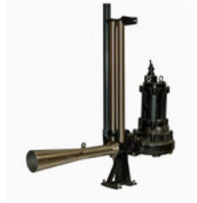
Dieser Tauchbelüfter (Ejektor) besteht aus einer Pumpe mit einer Strahlvorrichtung, wodurch das Wasser zur selben Zeit bewegt und belüftet wird. Die Pumpe ist mit einem verstopfungsfreien Kanallaufwerk ausgestattet.
