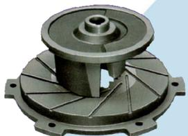
Eine im Laufrad integrierte Wolframkarbidklinge und der sägezahnartige innere Rand der Saugplatte bilden einen Schneidemechanismus, der zusammen mit dem Kanallaufrad verstopfungsfreies Pumpen ermöglicht. Faserige Feststoffe werden zerschnitten und mittransportiert.
