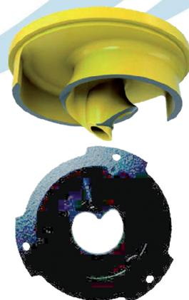
Einzigtiger Schneidemechanismus - Festkörper werden gleichzeitig zerquetscht und geschnitten. Die Saugplatte verfügt über eine feststehende Schaufel, die zusammen mit den zwei scharfkantigen Rändern des verstopfungsfreien Kanallaufrads einen effektiven Schneidemechanismus bildet. Feststoffe werden an der Saugplatte zerdrückt und gleichzeitig wie durch eine Schere in Stücke geschnitten.
