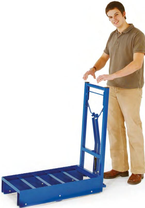
Über ein intelligent konstruiertes Hebelsystem bremsst der Rollwagen, beim Loslassen des Schiebegriffs, binnen weniger 1/100 Sekunden ab. Die Bremskraft, welche direkt auf jedes der beiden Räder aufgebracht wird, beträgt ca. 2500 N (ca. 250 kg)!!!
