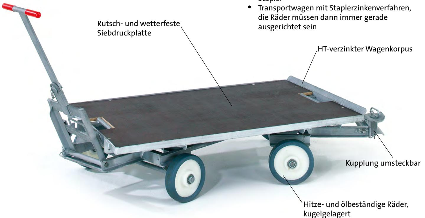
Durch Senkrechtstellen der Deichsel sind die Räder automatisch gerade ausgerichtet
