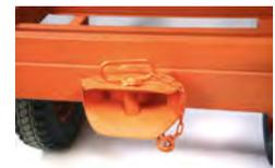
Anhängerkupplung/Bolzen ø 30 mm
