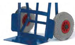
Die Sackkarren 22-9651/52 und 22-9661/62 haben an der Schaufelrückseite keine gerade Aufkantung, sondern ein zusätzlich nach hinten gewölbtes Flacheisen eingeschweißt. Dadurch lassen sich runde Gegenstände, wie z. B. Blumenkübel, besonders sicher transportieren, da ein seitliches Abrollen durch eine flächige Auflage in den gewölbten Sprossen vermieden wird.
