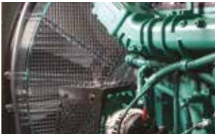
Rotierende und heiße Bauteile berührungssicher geschützt
