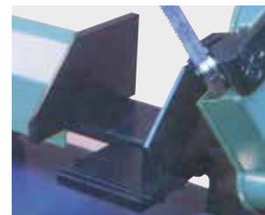
Schraubstock mit verlängerten Spannbacken und Werkstückauflage
