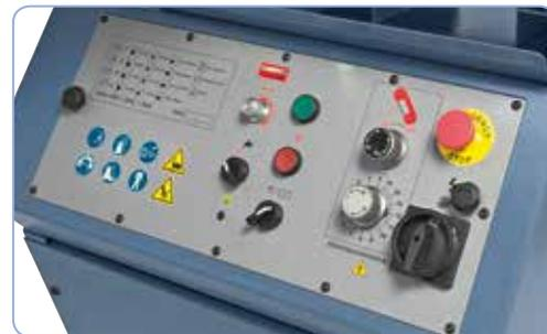
Drehschalter für stufenlose Schnittgeschwindigkeit und Regelventil für den Auflagedruck am ergonomisch angebrachten Bedientableau
