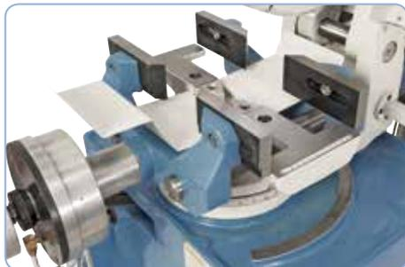
Pneumatischer Schnellspannschraubstock für kurze Rüstzeiten
