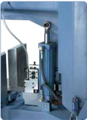
Ein konstantes Absenken des Sägebügels wird durch den robusten Hydraulikzylinder gewährleistet.
