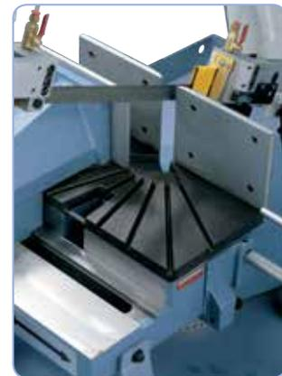
Schnellspannschraubstock zum Doppelgehrungsschneiden verschiebbar
