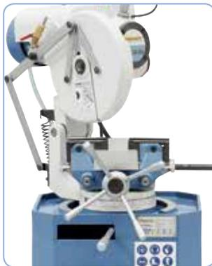
Schwenkbarer Getriebekopf (45° links / rechts), optimal für Gehrungsschnitte.
