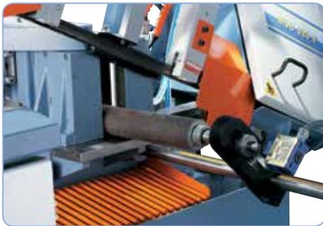
Der Werkstückanschlag mit Endabschaltung des Rollenvorschubes ist ideal für Serienarbeiten.
