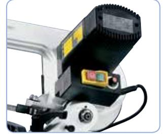
Leistungsstarker Antriebsmotor mit elektronischem Drehzahlregler.
