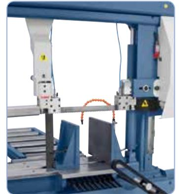
Die verschiebbare Sägebandführung kann optimal an die Werkstückbreite angepasst werden.
