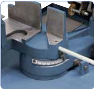
Schwenkbarer Sägebügel für Gehrungsschnitte bis 60°
