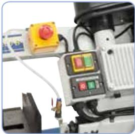
Zentrale Anordnung der Schaltelemente am Sägebügel
