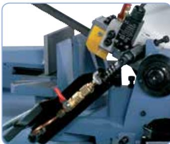
Hydraulikzylinder für stufenloses Absenken des Sägebügels.
