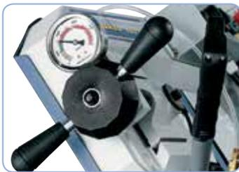
Optimales Einstellen der Sägebandspannung mittels Manometer.
