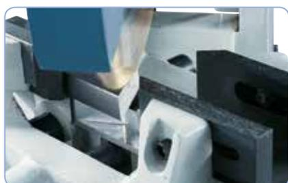
Schwenkbarer Getriebekopf (45° links / rechts), optimal für Gehrungsschnitte.
