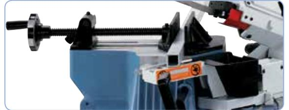
Inklusive Schnellspannschraubstock und Späneauffangbehälter.
