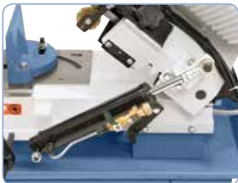
Serienmäßig mit Hydraulikzylinder für stufenloses Absenken des Sägebügels.
