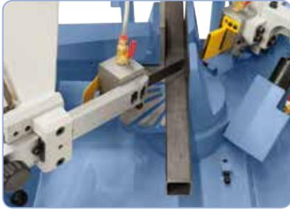
Schwenkbarer Sägebügel zum Gehrungsschneiden von 90° bis 60°
