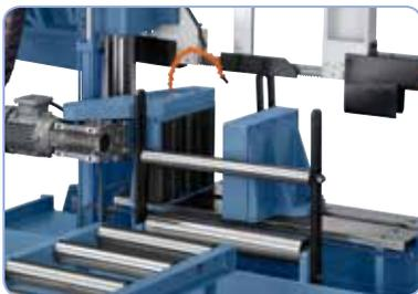
Motorisch angetriebener Rollenvorschub für optimalen Materialtransport.
