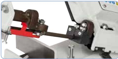
Kugelgelagerte Sägebandführung für präzise Schnitte
