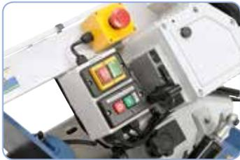
Übersichtliche Anordnung der Schaltelemente am Sägebügel.
