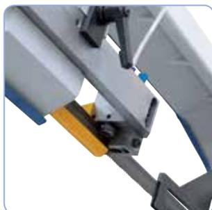
Sägebandführung über kombiniertes Rollen-Backenführungssystem mit Hartmetalleinsätzen
