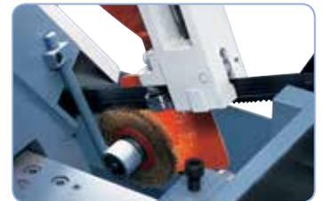
Kugelgelagerte Sägebandführung und Spänebürste für optimale Schnittergebnisse.
