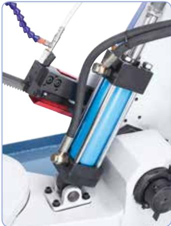
Serienmäßig mit Hydraulik-Absenckzylinder für stufenloses Absenken des Sägebügels und automatischer Endabschaltung nach Materialdurchschnitt.
