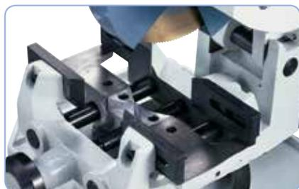
Massiver, selbstzentrierender Schraubstock mit längsverschiebbaren Spannbacken.
