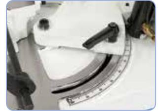
Schwenkbarer Sägebügel zum Doppelgehrungsschneiden von +45° bis -60°.
