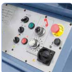
Komfortable Einstellung der Absenkgeschwindigkeit mittels Regelventil.
