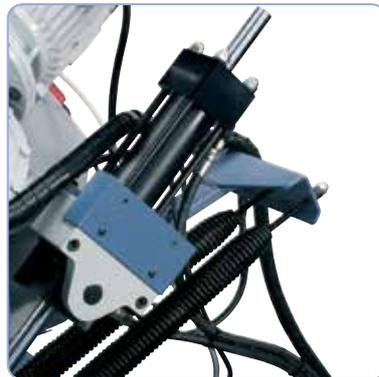
Stark dimensionierter Hydraulikzylinder, für Dauerbetrieb ausgelegt
