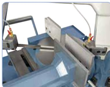
Der Säge Schlitz im Drehteller bewegt sich gleichzeitig mit dem Sägebügel.
