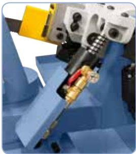
Serienmäßig mit Hydraulikzylinder für stufenloses Absenken des Sägebügels
