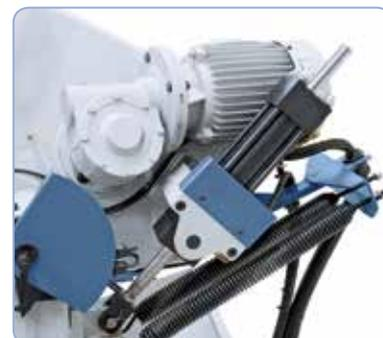
Stark dimensionierter Hydraulikzylinder, für Dauerbetrieb ausgelegt
