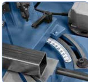
Schwenkbarer Sägebügel für Gehrungsschnitte bis 60°
