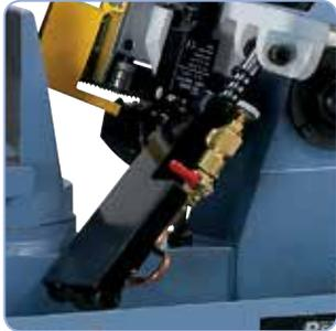
Für feinfühliges Absenken des Sägebügels serienmäßig mit Hydraulikzylinder ausgestattet.
