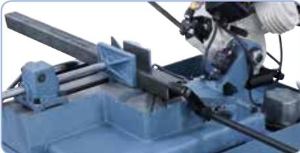
Einfache Verstellung des Schraubstockes mittels Schnellspannhebel.
