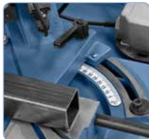
Schwenkbarer Sägebügel für Gehrungsschnitte bis 60°
