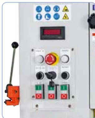
Serienmäßig mit LED-Drehzahlanzeige, zum Einstellen der gewünschten Schnittgeschwindigkeit
