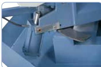
Der Hydraulikzylinder klemmt den Sägebügel auf den eingestellten Schnittwinkel.
