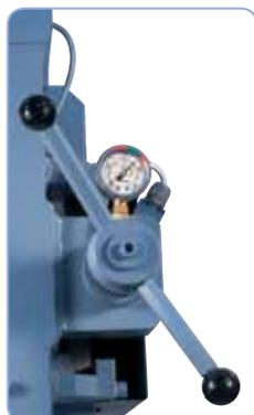
Ein exaktes Einstellen der richtigen Sägebandspannung erfolgt über das serienmäßige Manometer.
