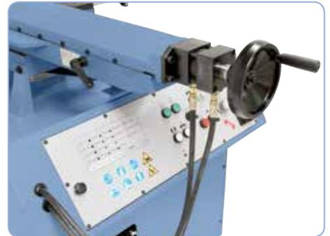
Verschiebbarer Schraubstock, Klemmung erfolgt manuell oder hydraulisch.
