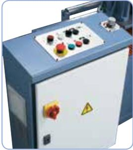
Ergonomisch angebrachter Schaltkasten an der Vorderseite der Maschine für komfortables Arbeiten.
