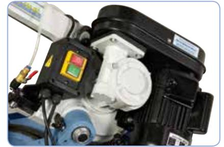
Mittels Keilriemen kann die Schnittgeschwindigkeit (23 / 33 / 52 m/min) gewechselt werden.
