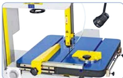
Längsanschlag für Geradeschnitte und Gehrungsanschlag für Winkelschnitte serienmäßig
