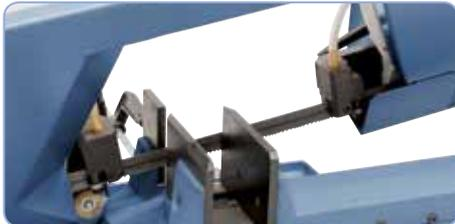
Kugelgelagerte Sägebandführung für präzise Schnitte
