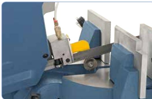
Kombinierte Rollen-Hartmetallführung verhindert schnellen Verschleiß des Sägebandes.
