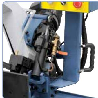
Großdimensionierter Hydraulikzylinder für stufenloses Absenken des Sägebügels
