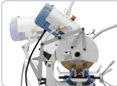
Schutzabdeckung öffnet automatisch beim Absenken des Getriebekopfes.
