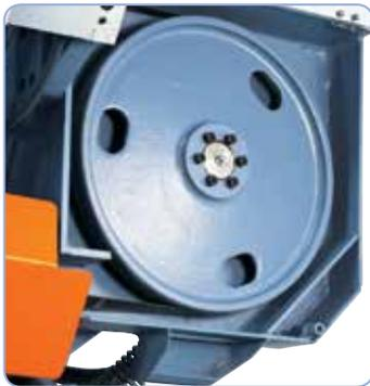
Die dynamisch ausgewuchteten Laufräder aus Grauguss sorgen für einen ruhigen Lauf.
