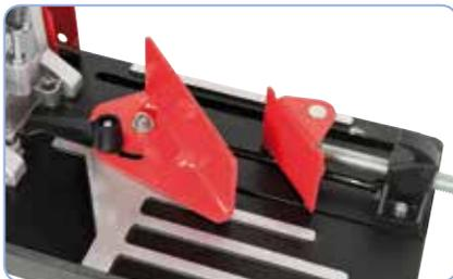
Schwenkbare Anschlagklappe für Gehrungsschnitte bis 45°.
