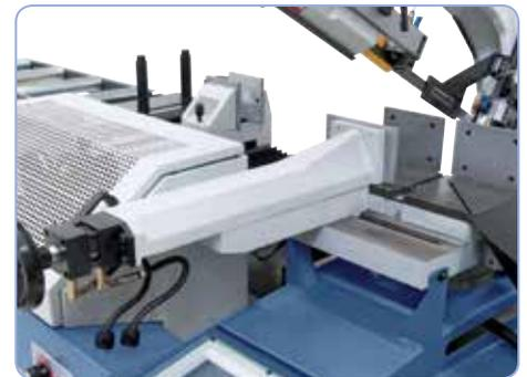
Hydraulischer Schraubstock zum Gehrungsschneiden verschiebbar.
