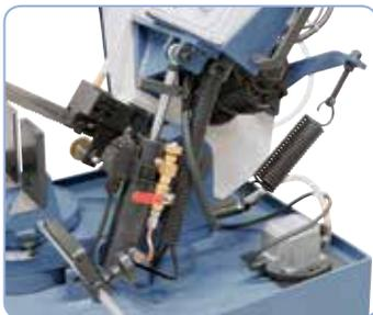
Hydraulikzylinder für stufenloses Absenken des Sägebügels.
