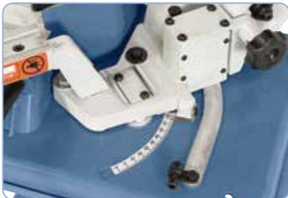
Verstellbarer Sägebügel zum Gehrungsschneiden
