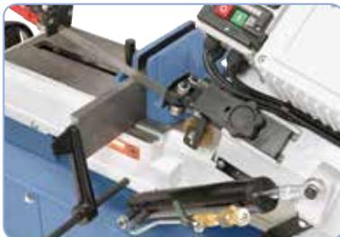
Schnellspannschraubstock mit Materialanschlag.
