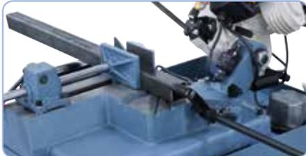
Einfache Verstellung des Schraubstockes mittels Schnellspannhebel.
