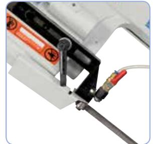
Kugelgelagerte Sägebandführung, einstellbar auf die jeweilige Werkstückbreite.
