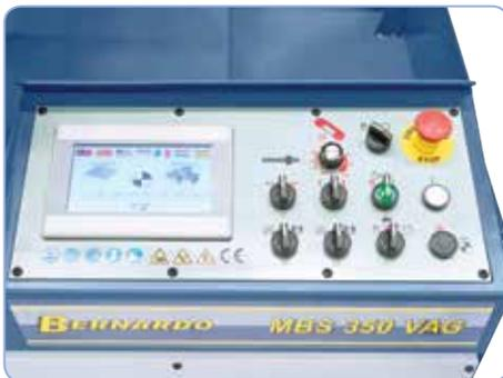
Übersichtlich aufgebautes Bedienpaneel mit integrierter NC-Steuerung.
