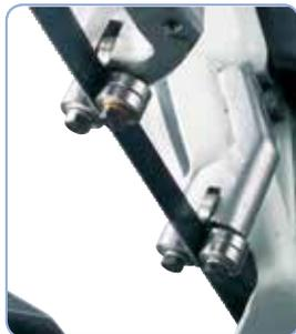
Kugelgelagerte Sägebandführung mit Schnellverstellung zum Anpassen an die Werkstückbreite garantiert ein optimales Arbeitsergebnis.
