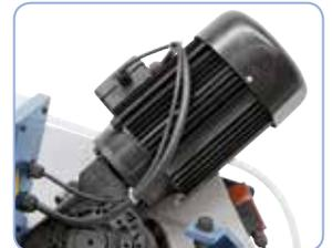
Leistungsstarker Graugußmotor nach IP 54.
