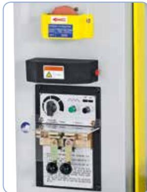
Inklusive Bandschweißeinrichtung mit Ausglühvorrichtung, Schere und Schleifstein
