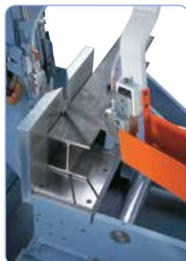
Sägebandführung mit Schnellverstellung zum Anpassen an die Werkstückbreite garantiert ein optimales Schnittergebnis.
