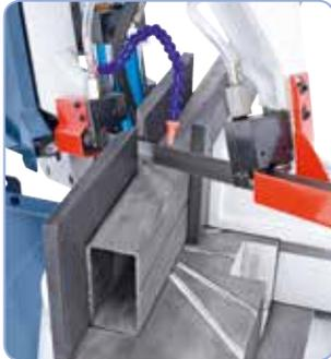
Schnellspannschraubstock zum Doppelgehrungsschneiden verschiebbar.
