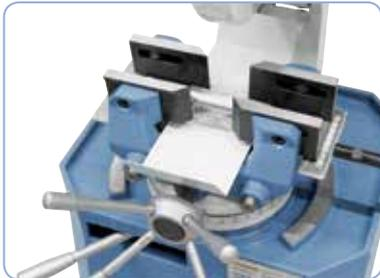
Zentrisch spannender Schraubstock mit längsverschiebbaren Spannbacken.
