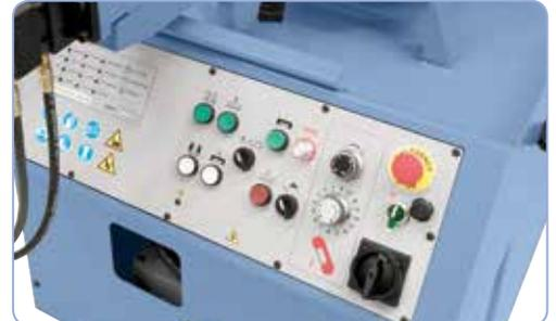
Drehesalter für stufenlose Schnittgeschwindigkeit und Regelventil für den Auflagedruck am ergonomisch angebrachten Bedientableau
