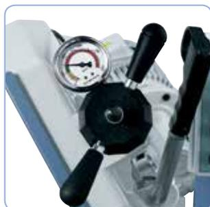
Kontrolle der Sägebandspannung mittels Manometer.
