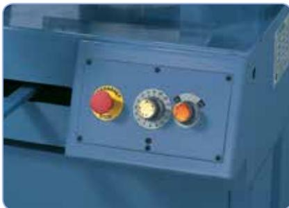
Komfortable Einstellung des Auflagedrucks mittels Regelventil.
