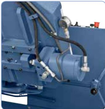
Optional mit hydraulischer Sägebandspannung lieferbar
