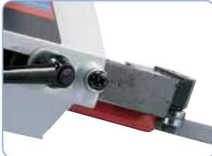
Kugelgelagerte Sägebandführung für optimale Schnittergebnisse.
