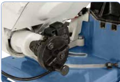
Auflagedruck des Sägebügels 3-fach einstellbar
