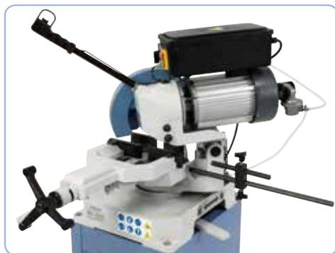
Getriebekopf nach rechts und links 45° schwenkbar
