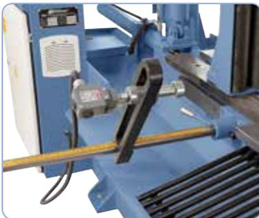
Manuelle Voreinstellung der Materiallänge mittels Mikroschalter, Eingabe und Kontrolle der Stückanzahl am Bedienpult.
