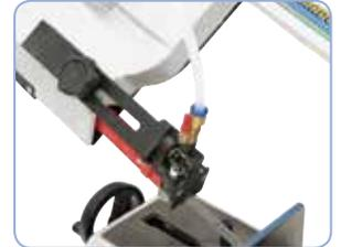
Kugelgelagerte Sägebandführung, einstellbar auf die jeweilige Werkstückbreite.
