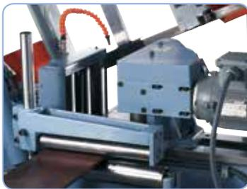
Der Schraubstock ist serienmäßig mit motorisch angetriebenen Rollen für den Werkstückvorschub ausgestattet.
