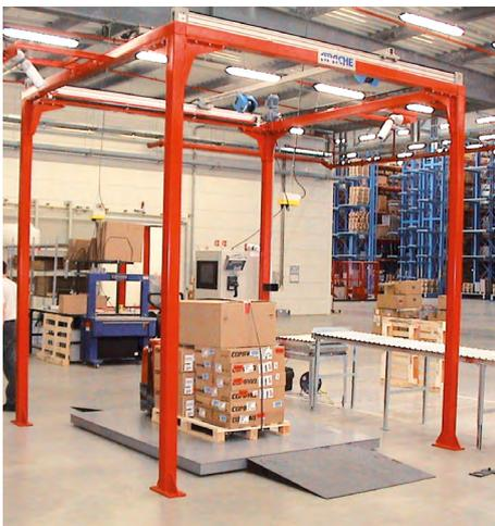
Volumenportal, Bodenwaage mit Auffahrrampe
