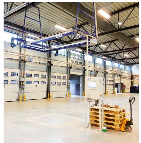
Deckenmodul Volumen, Bodenwaage eingebaut, Bedieneinheit
