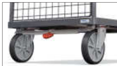
TOTALSTOP - Das Zentralbremssystem Mit nur einem Fußtritt werden Raddrehung und Schwenkbewegung beider Lenkrollen blockiert. Das Bremspedal bleibt immer im Sichtfeld des Bedieners.
